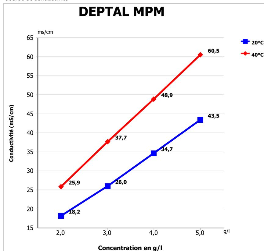
Si l'appareil de mesure intègre une compensation de température alors se référer à la courbe correspondant à la température de référence.
